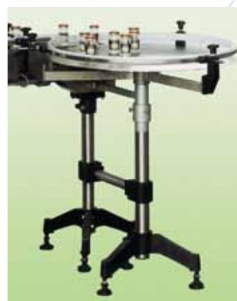
Tavola rotante di accumulo MT19 Out feed rotary table MT19 Table tournante d'accumulation MT19
