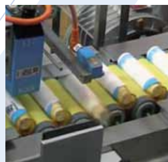
Controllo avvenuta etichettatura CS03-CS04-CS05 Label presence control CS03-CS04-CS05 Contrôle étiquetage arrivé CS03-CS04-CS05
